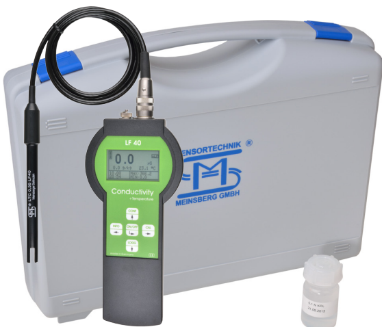
LF 40/Set mit Leitfähigkeitssensor LTC0,35/23-K010-U LF 40/Set with Conductivity Sensor LTC0,35/23-K010-U
